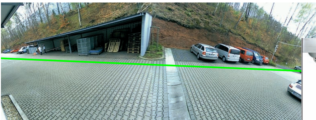
Optimale Ausrichtung der D12D-180°: Ebene Fläche wird korrekt dargestellt
