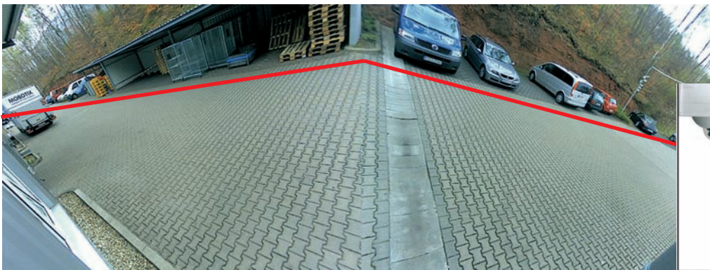
D12D-180° blickt zu steil nach unten: Ebene Fläche wirkt "geknickt"
